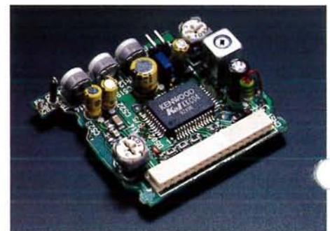
Particolare del chip K21 ultra stabile con commutazione automatica tra le bande IF larga e stretta.
